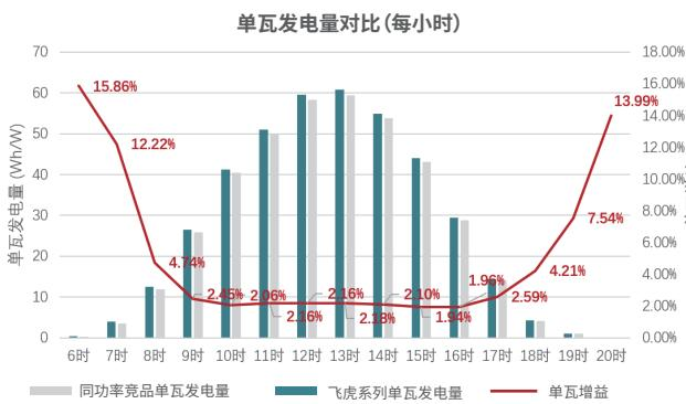
**3.早启晚停特性明显：**6时时段晶科飞虎组件单瓦发电功率较N型BC组件的增益达**15.86%**，更早进入有效发电状态；20时时段，该增益达**13.99%**，有效延长了每日发电时长。
