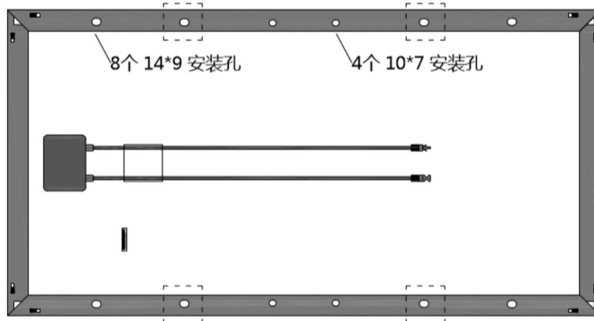
图4：螺丝固定的方法 (4个安装孔)
