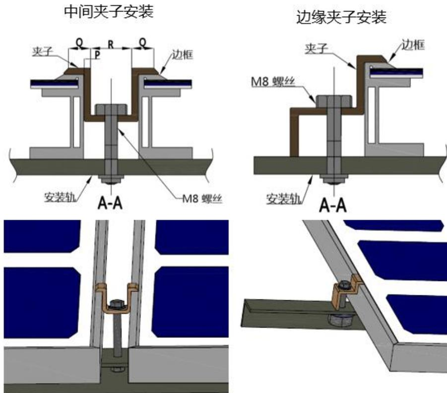
图6：夹子安装示意图
