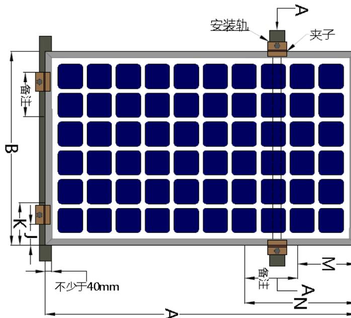
图9：组件长短边夹子固定方式
