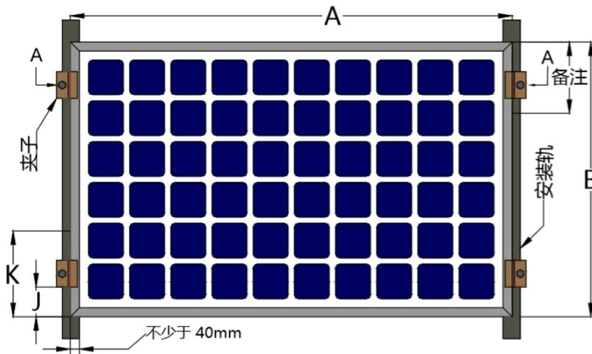
图8：组件短边夹子固定方式
