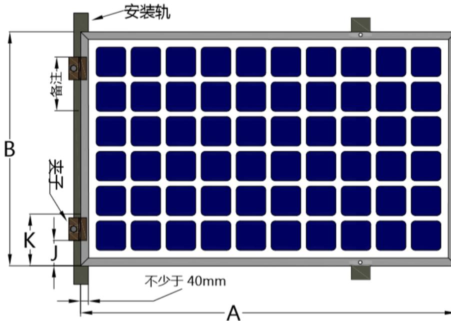
图10：夹子和螺丝的固定方法
